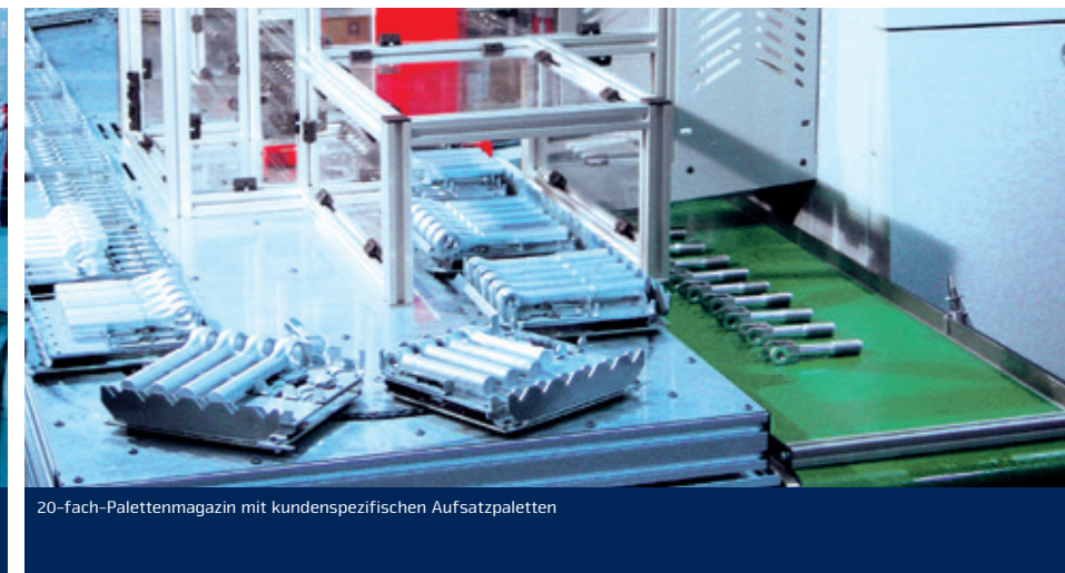
6-fach-Palettenaufsatz für Gelenkgabeln
