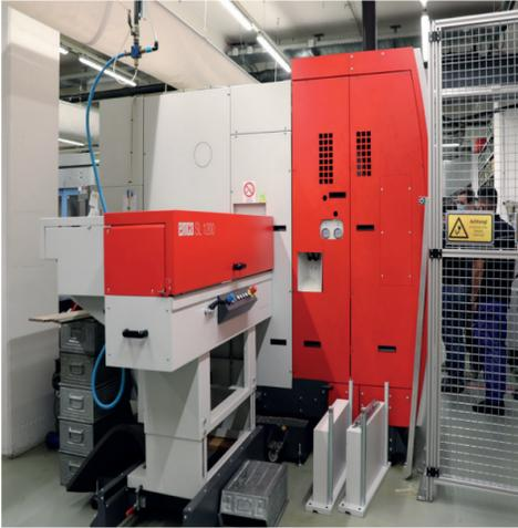
Das neue Fertigungssystem bei EVVA besteht aus dem Dreh-Fräszentrum Hyperturn 65 Powermill inklusive der Steuerungsoberfläche EMCONNECT von EMCO sowie Komplettautomatisierungspaket inkl. Emco-Kurzstangenlader SL 1200.
