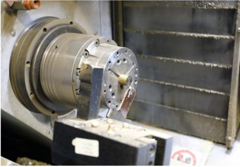
6-Seiten-Komplettbearbeitung: Die Hyperturn 65 Powermill ist mit einer Haupt- und Gegenspindel (5.000 U/min), einem BMT-Revolver (12.000 U/min) inkl. Y-Achse für maximal zwölf angetriebene Werkzeuge sowie einer 18.000er Frässpindel mit B-Achse ausgestattet und ermöglicht damit die Komplettbearbeitung verschiedener Gehäuseteile aus Messing in Trockenbearbeitung ab Losgröße 1.
